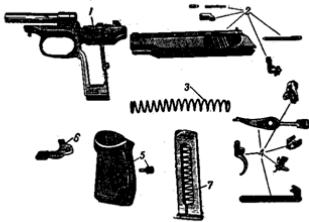
Рис. 2. Общее устройство пистолета ПМ
