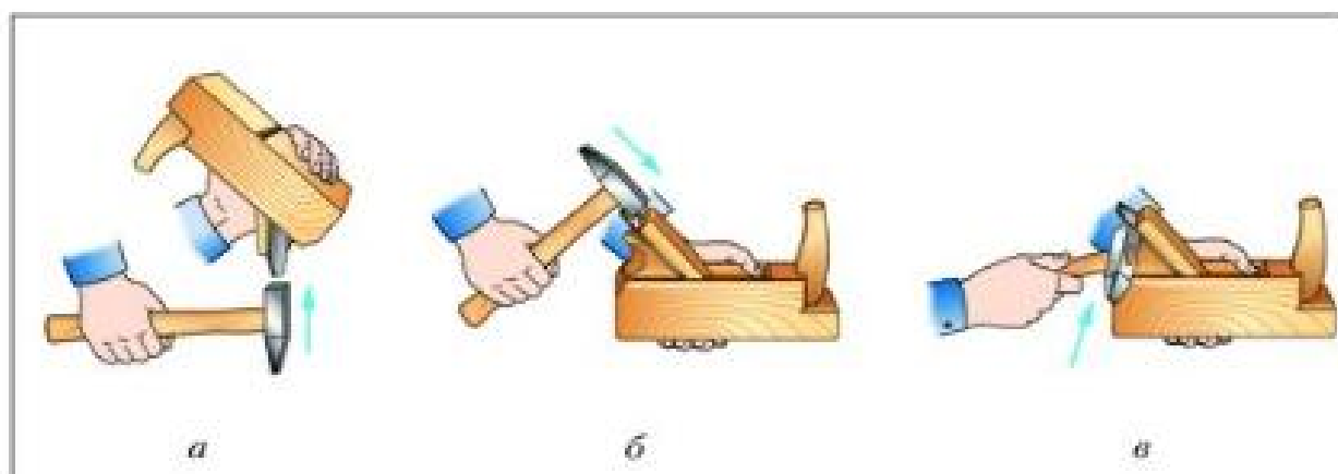
Рис. 10. Установка ножа в рубанок с деревянной колодкой: а – настройка выступа лезвия над подошвой; б – закрепление ножа с помощью клина; в – устранение перекося ножа
