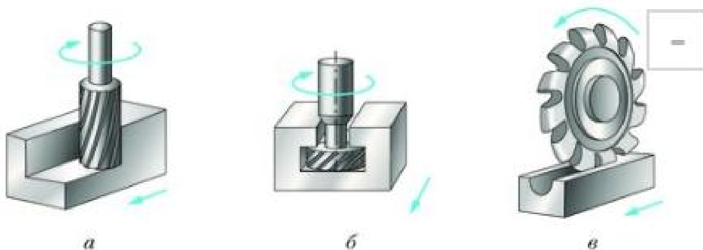
Рис. 55. Виды фрез: а, б – концевые; в – фасонная
