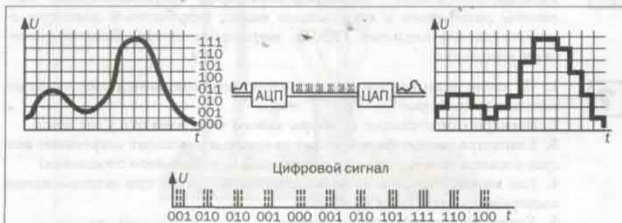
Рис. 48. Преобразование аналогового сигнала в цифровой и обратное преобразование цифрового сигнала в аналоговый после передачи информации
