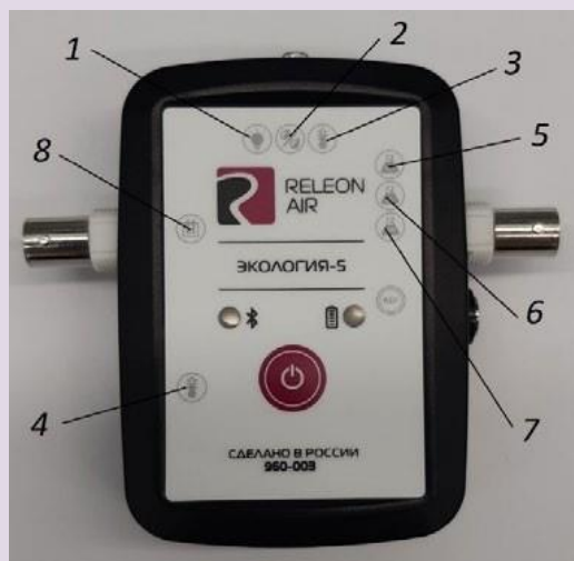
Рис. 2. Мультидатчик по экологии. Обозначение разъёмов и технологических отверстий: 1 — освещённость, 2 — относительная влажность воздуха, 3 — температура окружающей среды, 4 — температура растворов, 5 — нитрат-ионы, 6 — хлорид-ионы, 7 — рН, 8 — электропроводность
