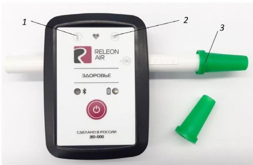
Рис. 3. Мультидатчик по физиологии. Обозначение разъёмов и технологических
