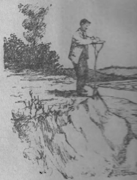
Рис. 36. Съёмка полуглазомерным способом
