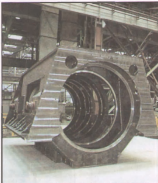
Корпус статора турбогенератора, выпускаемого на АО «Привод». Лысьвенские турбогенераторы малой и средней мощности, электроприводы и погружные двигатели успешно работают на пяти континентах и во всех климатических зонах мира
