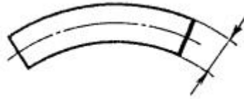
Рисунок 21а - Пример нанесения размеров деталей
