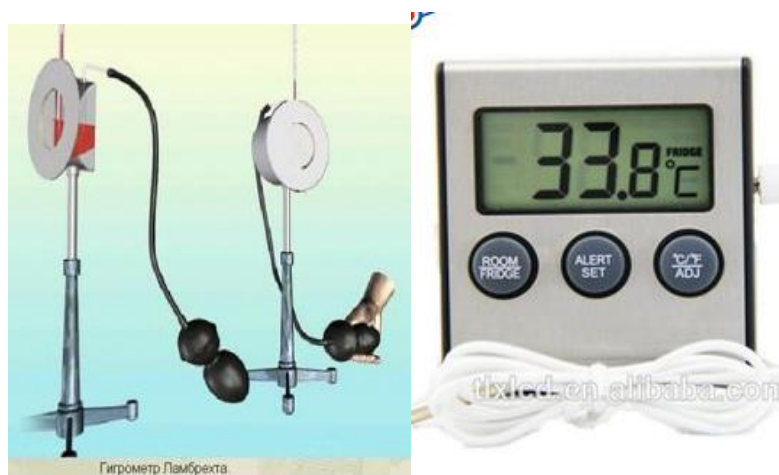
Конденсационный гигрометр Электрический термометр
