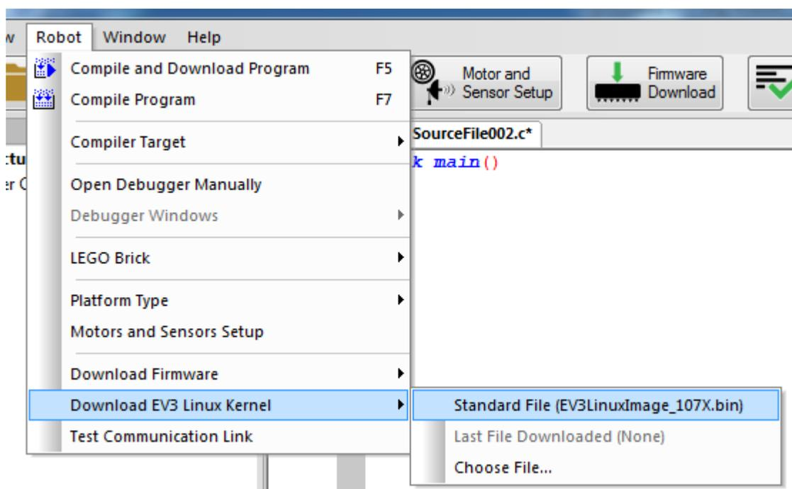
Когда установка завершится во второй раз, нужно выбрать кнопку на главном экране Firmware Download (установить основную прошивку). После этого с EV3 можно работать.
