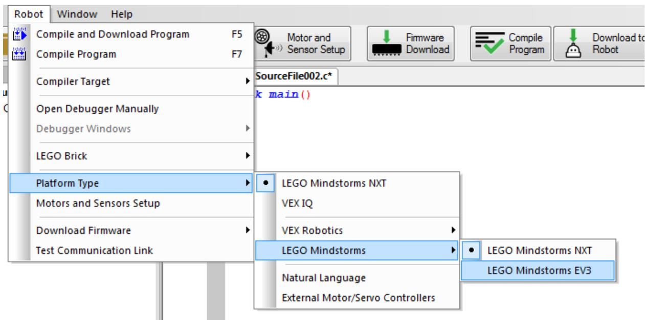
Открываем снова вкладку Robot и видим, что у EV3 и NXT она немного отличается. Выбираем пункт Download EV3 Linux Kernel -> Standard File. У вас запустится установка. Пока она идет КАТЕГОРИЧЕСКИ НЕЛЬЗЯ трогать EV3. Запустить эту установку нужно два раза (т.е. после окончания запустить еще раз).
