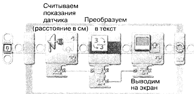
Рис. 184. Программа, отображающая на экране расстояние до объекта
