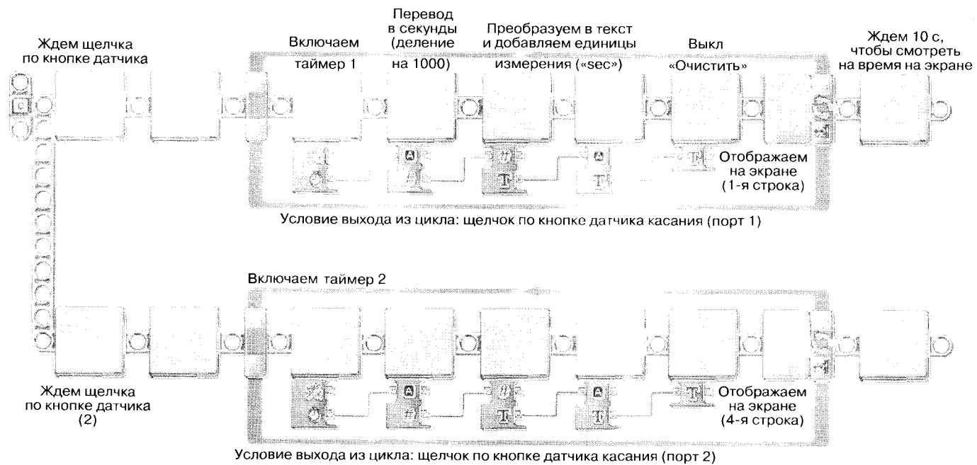
Рис. 258. Общая схема алгоритма работы секундомера
