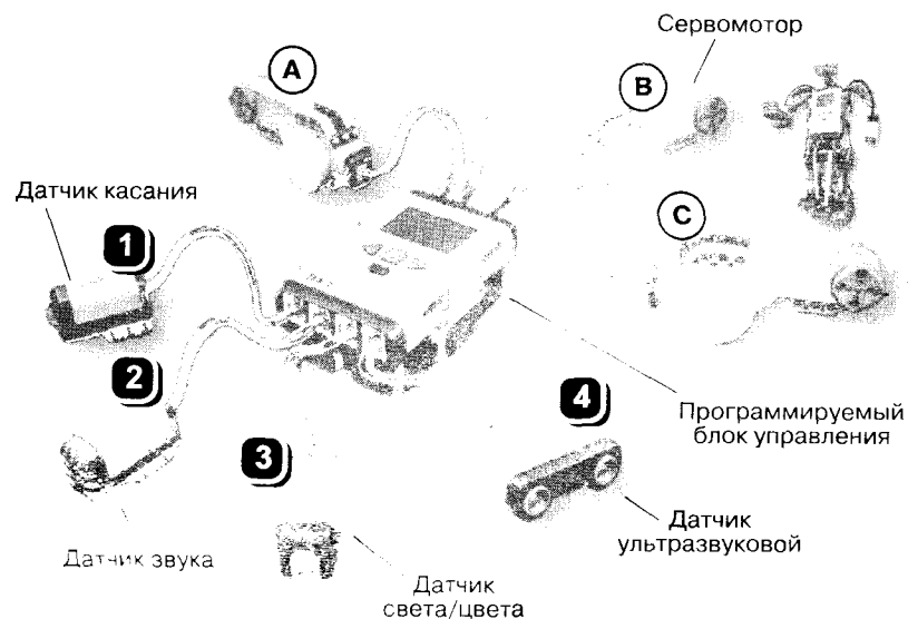
Рис. 1. Структура набора LEGO Mindstorms NXT
