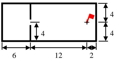
73. Задача № 13. Пожар произошел в здании поликлиники размером в плане  $12 \times 20$  м. Пожарная нагрузка однородная и размещена равномерно по площади помещения.
