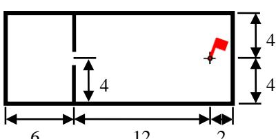
72. Задача № 12. Пожар произошел в заготовительном цехе размером в плане  $8 \times 20$  м. Пожарная нагрузка однородная и размещена равномерно по площади помещения.
