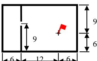
71. Задача № 11. Пожар произошел в заготовительном цехе размером в плане  $8 \times 20$  м. Пожарная нагрузка однородная и размещена равномерно по площади помещения.
