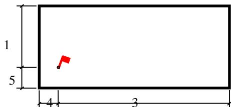
65. Задача № 5. Пожар произошел в деревообрабатывающем цехе размером в плане  $18 \times 30$  м. Пожарная нагрузка однородная и размещена равномерно по площади помещения.
