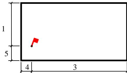
80. Задача № 20. Пожар произошел в административном здании III степени огнестойкости, размером в плане 18×36м. Пожарная нагрузка однородная и размещена равномерно по площади помещения. Время свободного развития пожара – 10 мин.
