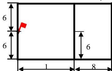
74. Задача № 14. Пожар произошел в здании поликлиники размером в плане  $12 \times 20$  м. Пожарная нагрузка однородная и размещена равномерно по площади помещения.
