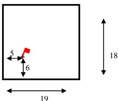
78. Задача № 18. Пожар произошел на торговом предприятии III степени огнестойкости, размером в плане  $18 \times 30$ м. Пожарная нагрузка однородная и размещена равномерно по площади помещения. Время свободного развития пожара – 12 мин.
