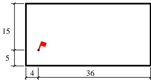
64. Задача № 4. Пожар произошел в помещении торгового центра размером в плане  $20 \times 40$  м. Пожарная нагрузка однородная и размещена равномерно по всей площади помещения.
