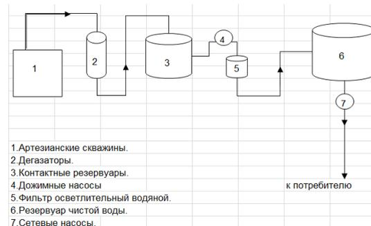
Рисунок 3. Технологическая схема подъема и очистки воды.
