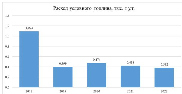
Расход условного топлива автоматизированной паровой котельной
