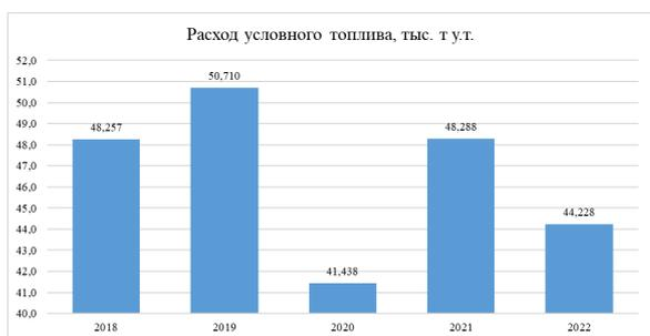
**Рисунок 1. Суммарный расход условного топлива котельными ЛГ МУП «УТВибВ»**
