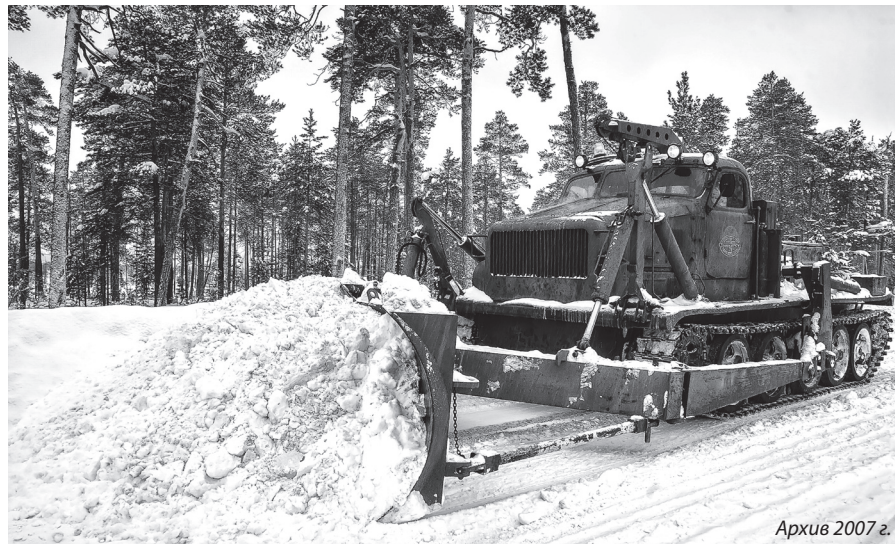
БАТ-М (бульдозер на артиллерийском тягаче - модернизированный), фото Евгения Бахарева
