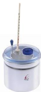
**6 шаг.** Отмерьте мензуркой **100 мл** горячей воды и перелейте во внутренний стакан калориметра. Вставьте термометр, дождитесь теплового равновесия и измерьте температуру горячей воды ( $t_2$ ). Результат прямого измерения запишите в таблицу № 1 с учетом абсолютной погрешности ( $\Delta t$ ), равной цене деления шкалы термометра.
