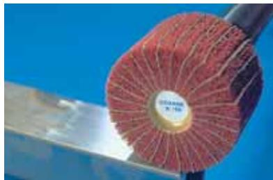
Шлифовальные колеса на шпинделе siavlies, один из самых плотных абразивных материалов на рынке, обладают повышенной износостойкостью. Изготовленные из нетканого объемного равномерно пропитанного абразивного материала, они обеспечивают как агрессивную обработку, так и завершающие финишные операции. Для более грубой обработки применяются шлифовальные колеса на шпинделе siavlies со вставками из абразивной шкурки.
