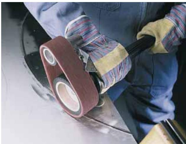
Специалисты компании **sia Abrasives Industries AG** рекомендуют применять низкие скоростные режимы при работе с абразивными материалами **sia SCM** для получения однородной матовой поверхности, при шлифовании алюминия, а также при обработке древесины.
