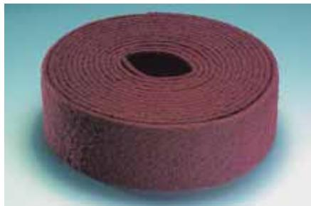
Узкие рулоны siavlies используются для ручного шлифования как самостоятельно, так и с использованием шлифовальных блоков. Возможность использования частей рулона различной длины, позволяет экономно расходовать абразивный материал. Узкие рулоны siavlies изготавливаются шириной минимум 50 мм и максимум 1700 мм, длиной 10, 20, 30, 40 и 50 метров.
