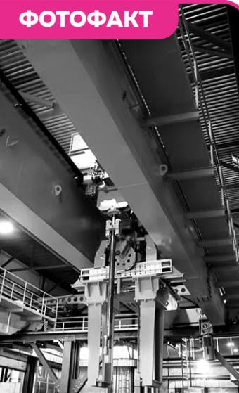
Томская электронная компания создала высокоточные порталные манипуляторы, которые комплексно управляют производственными процессами, в том числе перемещают изделия, оценивают стадию производства и соответствие параметрам.
