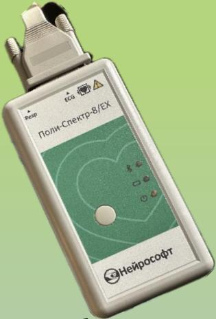
Возможное решение: необходимо проверить сопряжение прибора с планшетом, при необходимости, добавить его заново. В некоторых случаях помогает сброс настроек сети на планшете и его последующая перезагрузка. Так же, не исключаем разряженные аккумуляторы в приборе.
