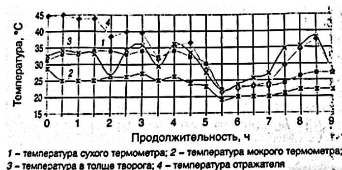
Рис.2 Изменение температуры в процессе сушки творога в слое 5 мм
