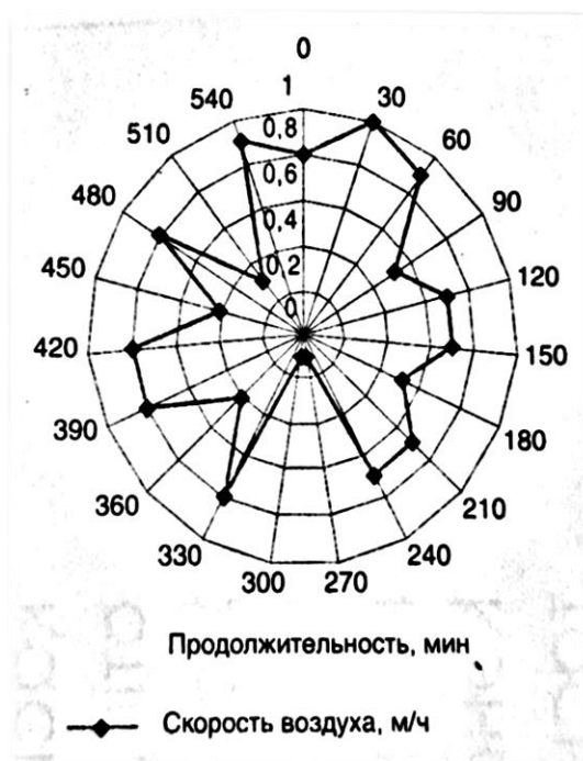
Рис.3 Скорость воздуха при сушке творога толщиной 5 мм
