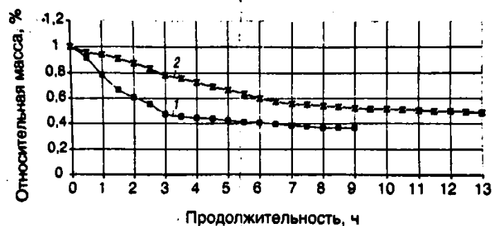
Рис.1 Изменение относительной массы творога при сушке в слое 5 мм (график 1) и 10 мм (график 2)
