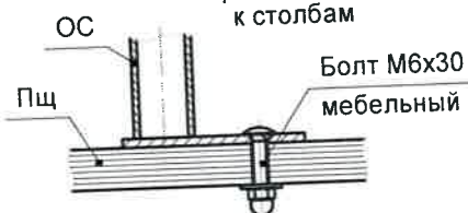
Рисунок 10 - Крепление опоры сиденья к площадке
